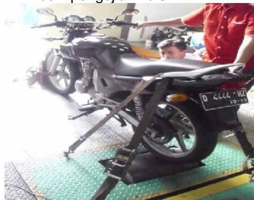
Gambar 5.2 Sepeda motor yang di uji di atas alat dynotest
